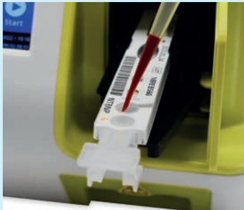
Patientenprobe auf Testkassette aufbringen.
