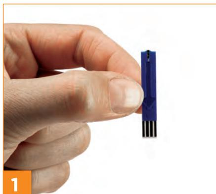
1 Teststreifen aus der Dose nehmen und in das Messgerät stecken.
