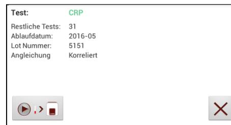
Eine aktive Korrelations-Anpassung ist beim jeweiligen Parameter im Test Screen vor durchführen eines Messungsvorgangs durch *Korreliert* gekennzeichnet.
