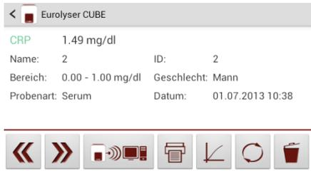
Das Testergebnis wird am Tablet PC angezeigt. Benutzen Sie und um durch die Ergebnisse durchzublätern. Tippen Sie auf um zu einem PC, einem HIS/LIS oder per E-Mail zu exportieren. Tippen Sie auf um zu Drucken. Tippen Sie auf um die Photometrische Datenkurve anzuzeigen. Tippen Sie auf um das Ergebnis zu löschen.
