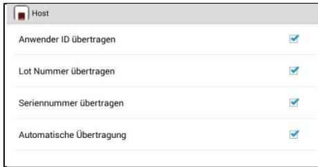
Tippen auf *Automatische Übertragung* erlaubt die automatische Übertragung der Informationen eines Messungsergebnisses nach einer erfolgreichen Messung über USB oder der seriellen Schnittstelle. *Anwender ID*, *Lot Nummer* und *Seriennummer* sind zusätzliche Informationen, die einer Übertragung angehängt werden können.
