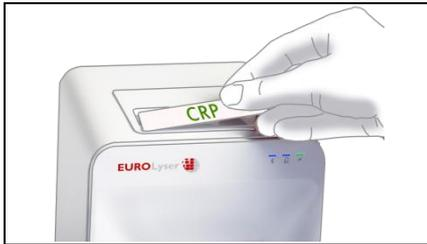
Entnehmen Sie die in der Testpackung mitgelieferte RFID Karte und legen Sie diese auf das Instrument an der vorgesehenen Stelle.
