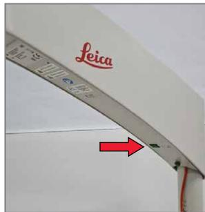
Operationsmikroskop am Hauptschalter ausschalten.
