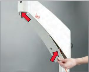
▶ Abdeckung des Horizontalarms einschieben und festschrauben.
