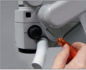
8 Hebel zum Verriegeln der vertikalen Position drehen.
