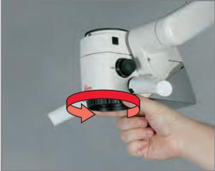
▶ Abdeckung an Optikträger entfernen.
