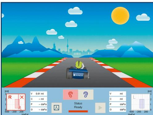
3. Dichtet der Ohrstöpsel nicht richtig ab oder bewegt das Kind den Kopf, stoppt das Rennauto mit einer Reifenpanne und die Messung muss wiederholt werden.
