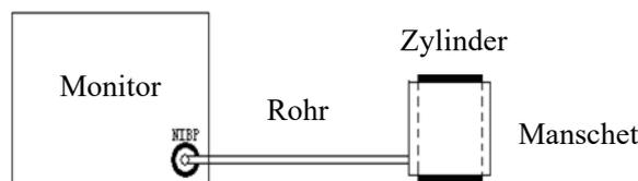
Abbildung 23-1 NIBP-Leckagetest-Anschlussdiagramm
