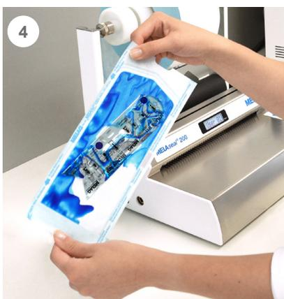
Verteilen Sie die Tinte durch Drehen der Klarsicht-Sterilisierverpackung gleichmäßig.
