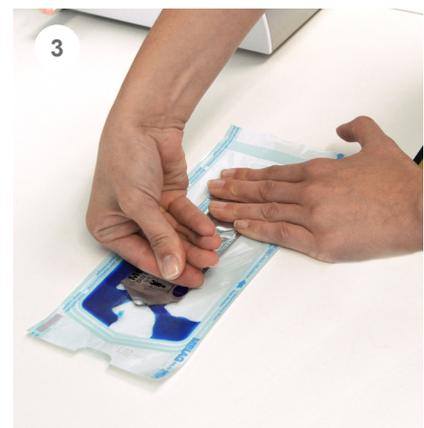
Streichen Sie mit leichtem Druck vom Ende bis zur Spitze über den Tintentest. Der Tintentest wird dadurch geöffnet und die Tinte herausgedrückt.
