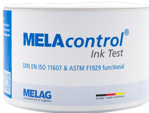
Die für den Test benötigte Tinte befindet sich in einem praktischen Einweg-Beutel. Der MELAcontrol Ink Test wird in einer Klarsicht-Sterilisierverpackung versiegelt. Danach wird die Tinte herausgedrückt. Mit der austretenden Tinte lassen sich alle vier Seiten der Verpackung prüfen. Unregelmäßigkeiten, Fehlstellen oder Kanäle in den Siegelnähten werden somit schnell sichtbar.
