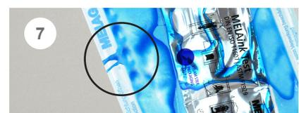
Tintentest nicht erfolgreich - durch die Tinte ist ein Kanal in der Siegelnaht sichtbar geworden.
