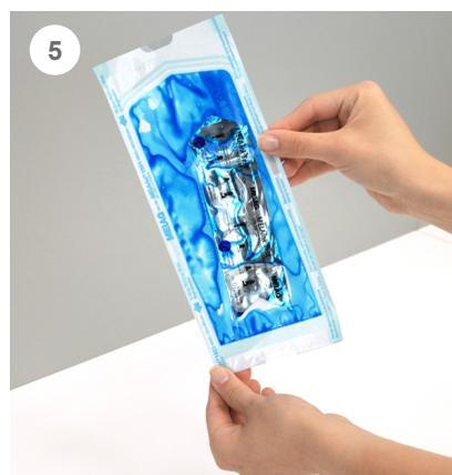
Lassen Sie die Tinte an jeder Siegelnaht ca. 5 s einwirken. Prüfen Sie alle Siegelnähte auf Dichtigkeit.
