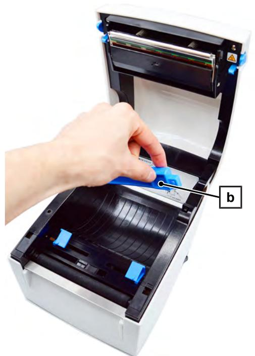
3. Heben Sie den Rollenhalter an und ziehen Sie ihn bis zum Anschlag heraus.
