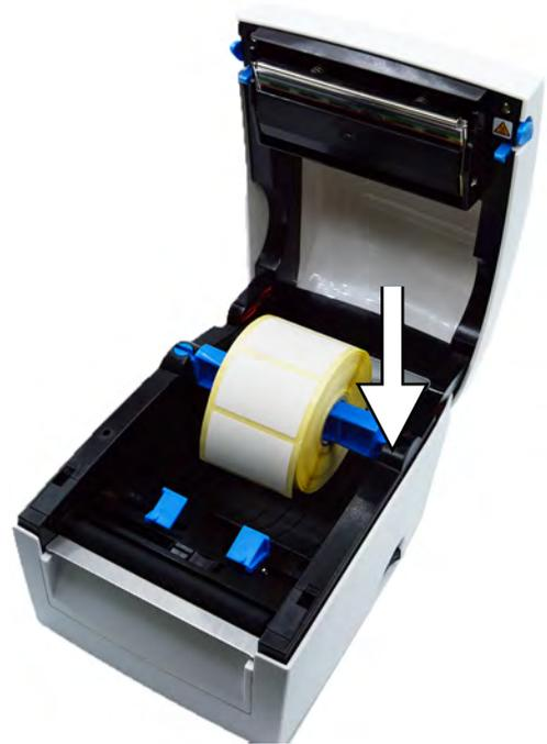
6. Schieben Sie das Druckmaterial unter die Materialführung (Pos. d) und ziehen Sie es nach vorn.
