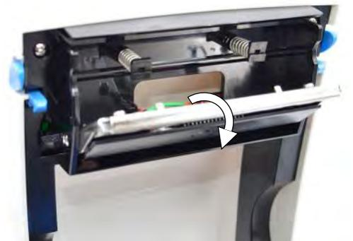
4. Lösen Sie den Druckkopfanschluss (Pos. a) und entfernen Sie die Druckkopfschrauben.
