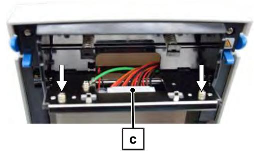
8. Klappen Sie den Druckkopfhalter wieder in die Ausgangslage und schließen Sie anschließend den Druckkopfhebel.
