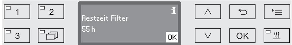
Im Display werden daraufhin die verbleibenden Betriebsstunden für diesen Filtertyp angezeigt.
