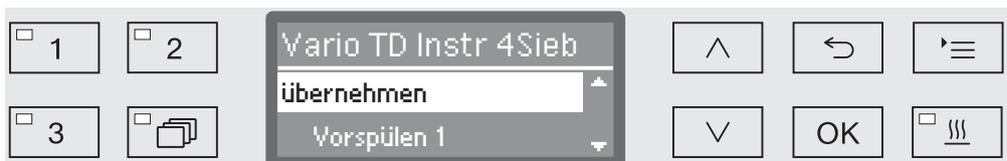
Im Display sind alle Spülblöcke aufgelistet, die dem Programm zugeordnet sind. Die Zuordnung kann bei Bedarf durch den Kundendienst angepasst werden.
