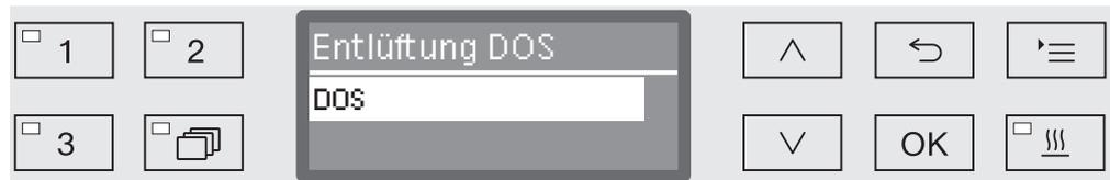
Mit der Auswahl des Dosiersystems startet die automatische Entlüftung. Einmal gestartet kann der Vorgang der automatischen Entlüftung nicht mehr abgebrochen werden.
