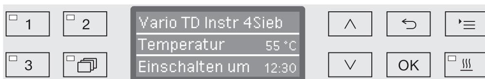
Im Display wird daraufhin das gewählte Programm mit der eingestellten Startzeit ausgegeben. Ist die automatische Abschaltfunktion aktiviert (siehe Kapitel "Erweiterte Einstellungen/Abschalten nach"), schaltet sich der Reinigungsautomat nach der eingestellten Zeit bis zum Programmstart aus.
