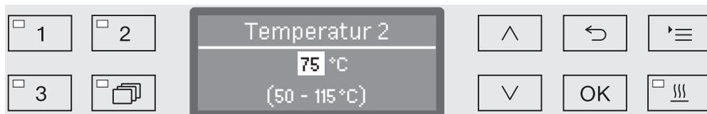
Die Temperatur wird in 5 °-Schritten eingestellt. In der untersten Zeile ist der mögliche Einstellungsbereich angegeben.
