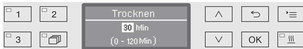
Ist die Zeit als veränderbar eingestellt, wird im Display die für dieses Programm voreingestellte Trocknungszeit in Minuten (Min) und in der untersten Zeile der mögliche Einstellungsbereich angegeben.
