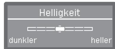
Kontrast und Helligkeit werden durch eine Balkenanzeige im Display eingestellt.
