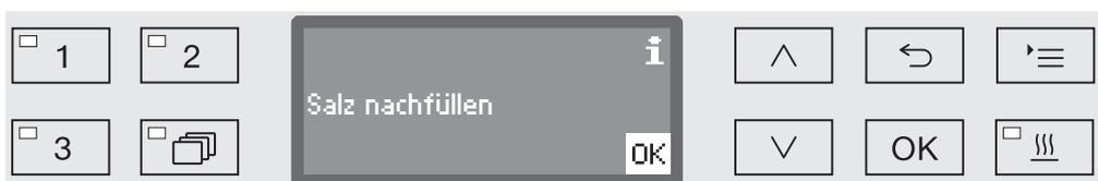
Systemmeldungen werden vor dem Start und am Ende eines Programms ausgegeben und müssen einzeln mit **OK** oder alle zusammen am Programmende durch Öffnen der Tür bestätigt (quittiert) werden. Wird das **i** Symbol im Display eingeblendet, können die Systemmeldungen durch drücken der **OK** Taste aufgerufen werden.
