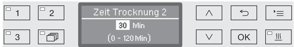
Die Haltezeit wird in 1 Minuten Schritten eingestellt. In der untersten Zeile ist der mögliche Einstellungsbereich angegeben.
