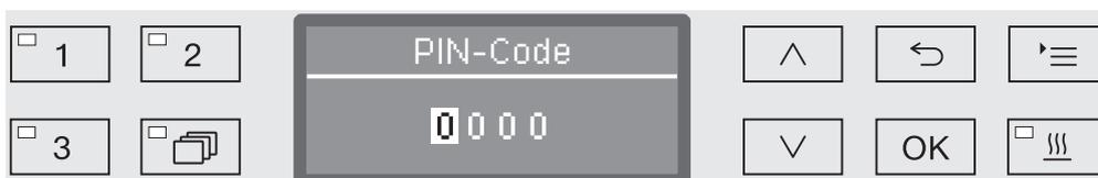
Falls Sie nicht über den PIN-Code verfügen, wenden sie sich bitte an einen Anwender mit entsprechenden Zugriffsrechten oder brechen Sie den Vorgang mit der Taste ↶ ab.
