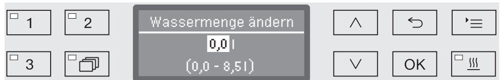
Die Wassermenge kann in 0,5 l Schritten erhöht oder wieder auf die Werkseinstellung zurückgesetzt werden. In der untersten Zeile ist der mögliche Einstellungsgebiet angegeben. Der Einstellung "0 l" entspricht der Werkseinstellung.
