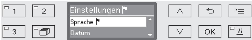
Mit Hilfe der Pfeiltasten  $\wedge$  und  $\vee$  auf dem Bedienpult kann durch das Menü navigiert werden.
